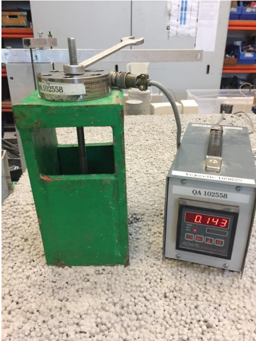
Figur 3. Påføring af træk i gevindstangen ved spænding af møtrikken. Aflæsning af træk i skruen i kN.
